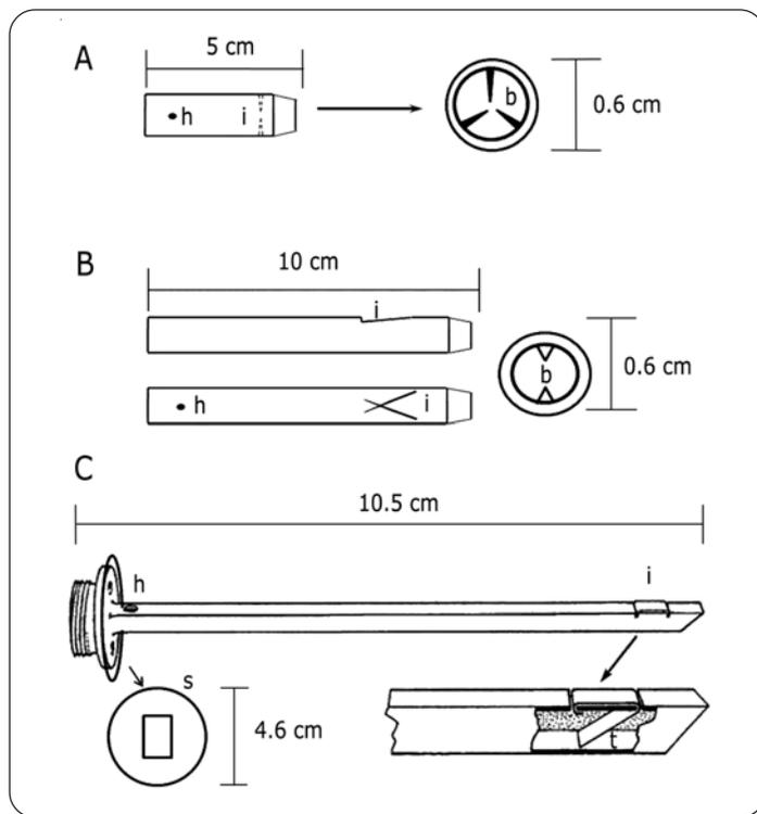
**Figure 1. Diagrams of steel darts used to obtain white shark biopsies. A) Dart 1; B) Dart 2 and C) RB dart. h: hole for water outflow; b: retention bars; t: trap-door; i: incisions for retention bars; s: stopper / Diagramas de los dardos de acero utilizados para colectar biopsias de tiburón blanco. A) Dardo 1; B) Dardo 2 y C) Dardo RB. h: orificio para el flujo de agua; b: ganchos de retención; t: puerta de corte; i: incisiones para los ganchos de retención; s: tope**
